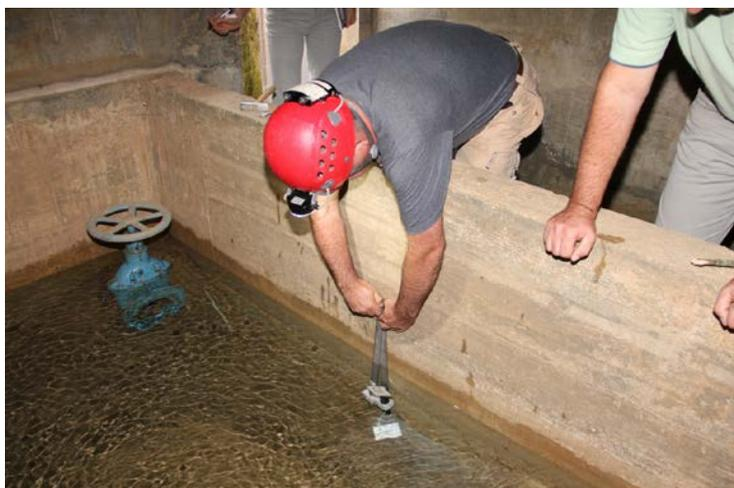
*Installazione di diver per la misurazione del livello dell'acqua, della conduttività elettrica e della temperatura presso la sorgente Kajža.*
