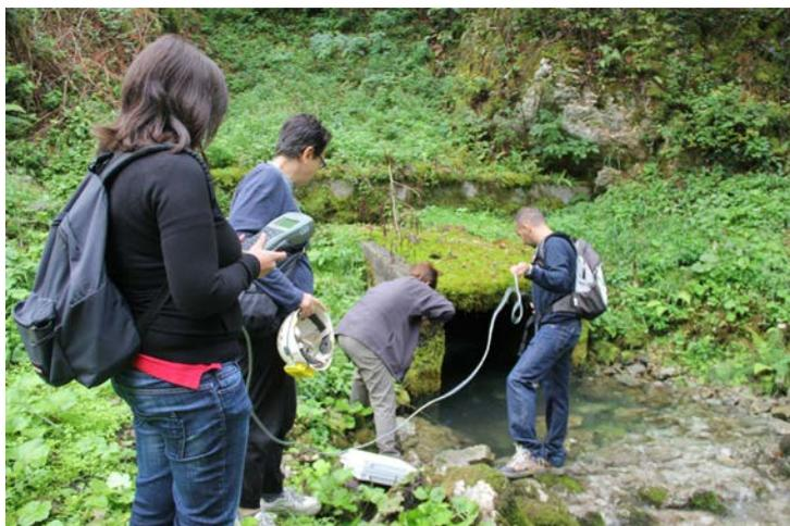
*Misurazione dei parametri fisici e campionamento dell'acqua per l'analisi chimica presso la sorgente Kajža.*
