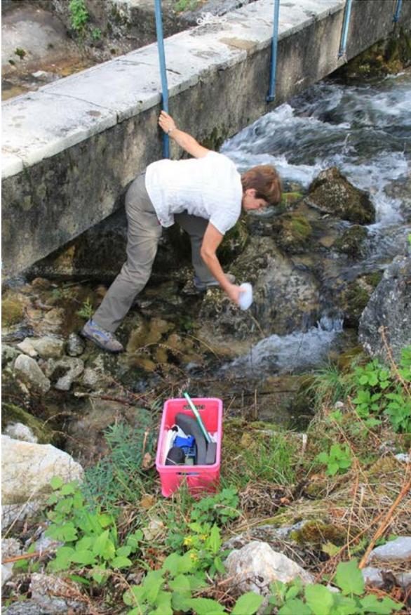
*Misurazione dei parametri fisici e campionamento dell'acqua per l'analisi chimica presso la sorgente Hubelj.*
