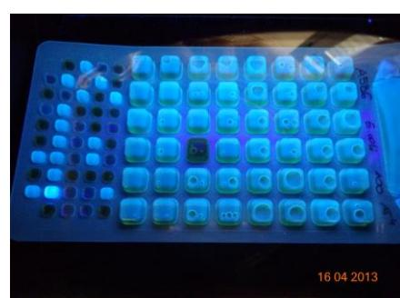
Slika 26, 27: Colilert: Quanti-Tray/2000 po inkubaciji
