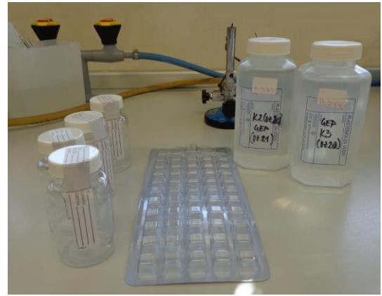
Slika 1: graduirane stekleničke, Quanti-Tray in vzorca vode
