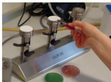
Slika 19: filter položimo na nosilec aparata
