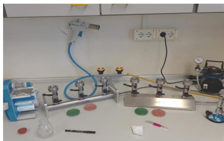
Slika 17: Aparat za membransko filtracijo
