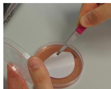
Slika 23: Filter položimo na m-enterococcus
