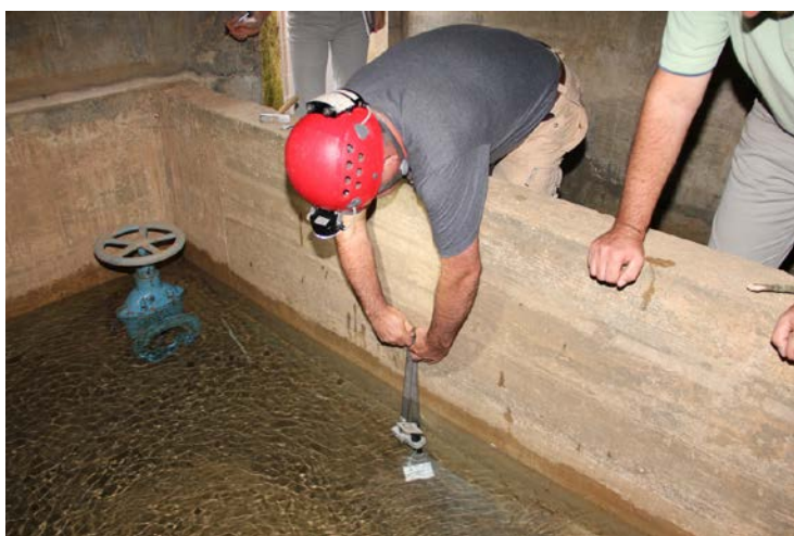
Postavitev merilnikov nivojev, specifične električne prevodnosti in temperature vode na izviru Kajža.
