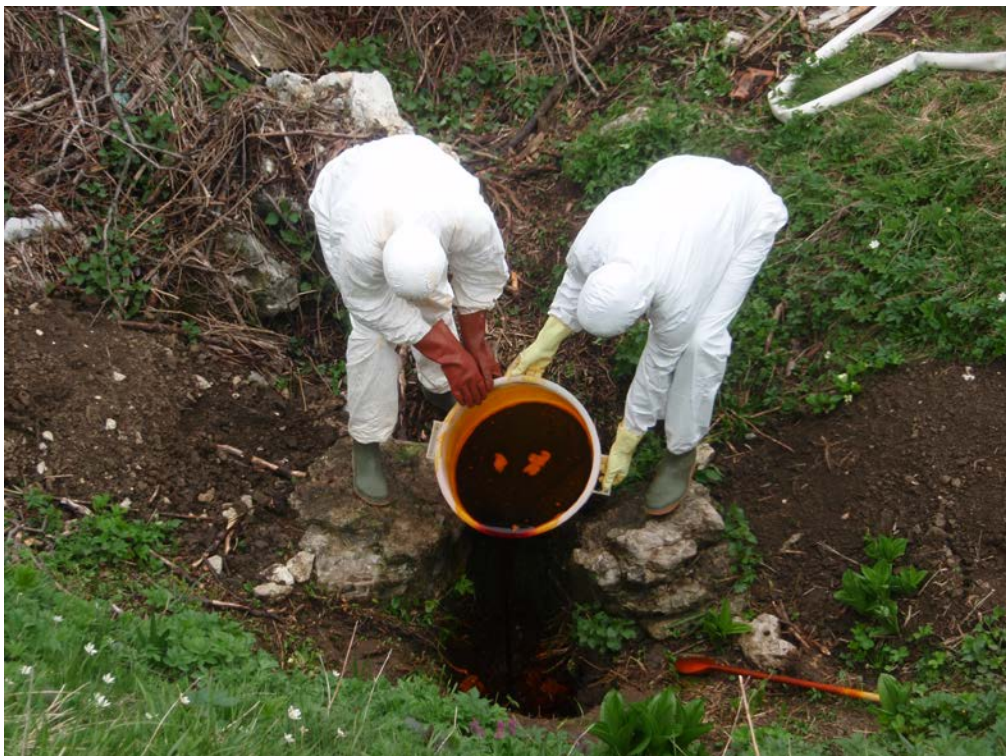
Sledilo uranin smo v razširjeno razpoko na površju injicirali 24. aprila 2014.
