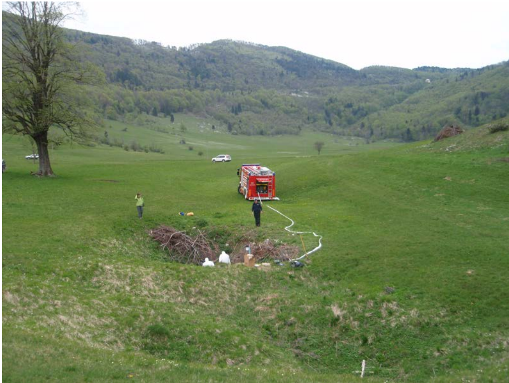
Za določitev razvodnice med izvirova Hubelj in Podroteja smo izvedli sledilni poskus z območja Malega polja pri Colu.
