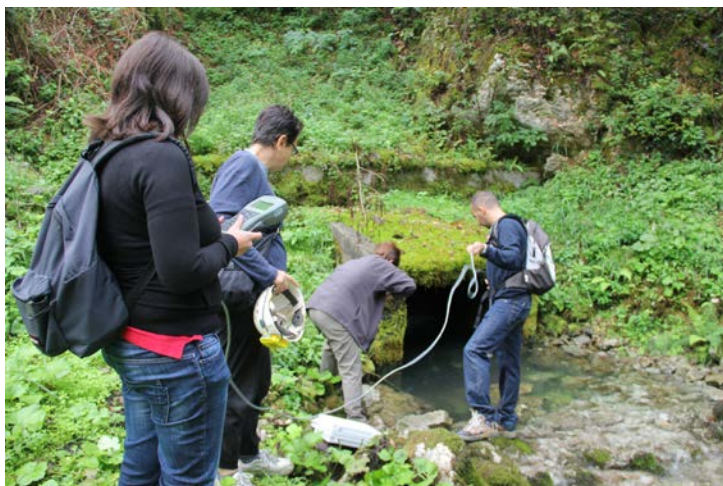
Merjenje fizikalnih parametrov in zajem vzorcev vode za kemijske analize na izviru Kajža.
